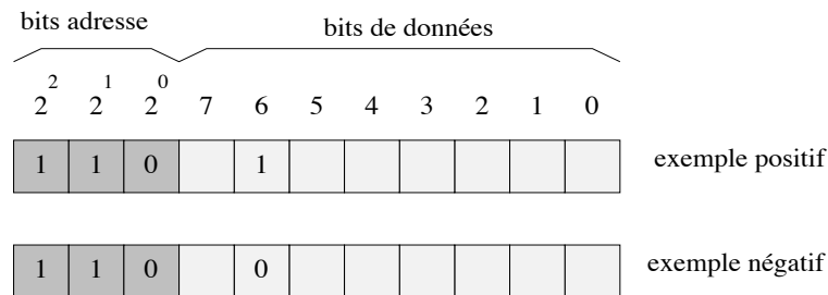
FIG. 2.7 – Le problème du "Multiplexer11": les 3 premiers bits définissent le bit adressé. Dans cet exemple il s'agit du 6 ème bit ( 1 \times 2^2 + 1 \times 2^1 + 0 \times 2^0 ). L'instance est positive dans le cas où le 6 ème bit vaut 1 et elle est négative dans le cas où le 6 ème bit vaut 0
